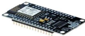
Fig 2: ESP8266 Wi-Fi module
